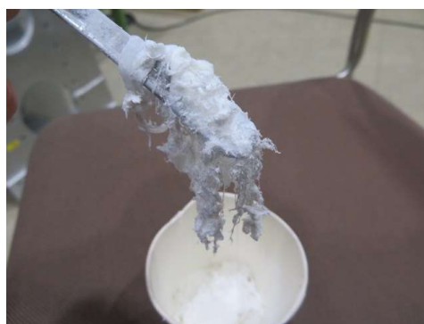
水ガラス25グラム上に酸化マグネシウム3グラムをのせてかき混ぜた様子(室温7℃)。繊維状になっている様子が観察できる。
